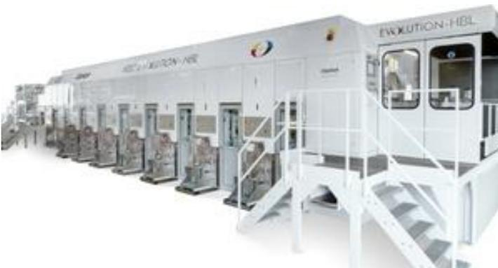
Rotationsstanze Evolution High Board Line Foto ©: Göpfert Maschinen GmbH
