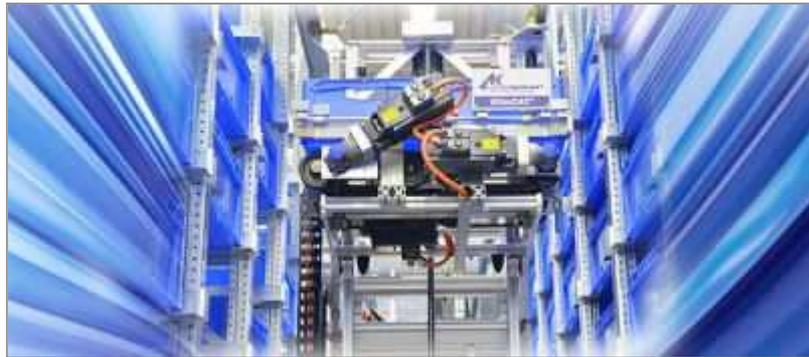
Deutlich mehr Leistung bei ähnlicher Kapazität, das bieten Shuttle-Systeme im Vergleich zu herkömmlichen Regalbediengeräten. Allerdings werden dadurch der technische Aufwand und das Investitionsvolumen für ein Lagersystem je nach Ausbaustufe deutlich höher. Ganz anders beim neuen Multilevel-Shuttle-System KlinCAT von Klinkhammer.
