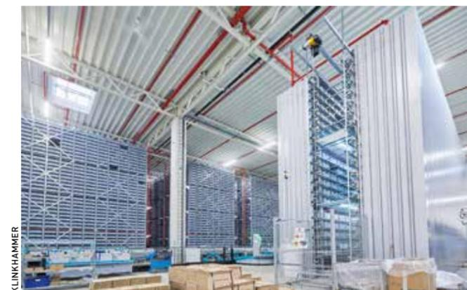
Ein Shuttle-System dient als Auftragszusammenführungspuffer.
