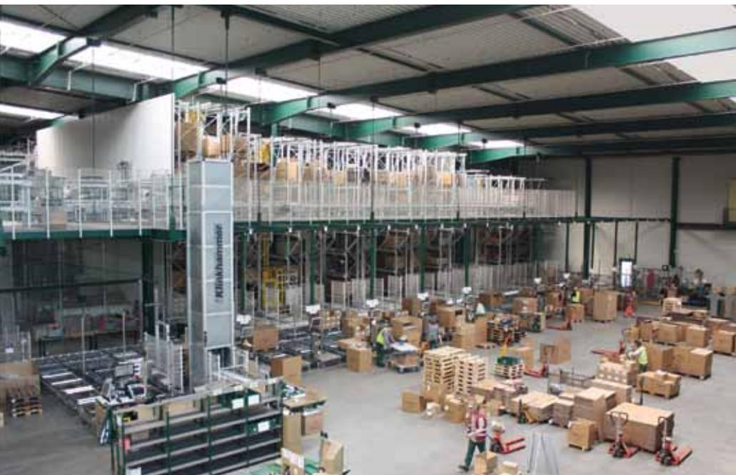
**Der Blick in das neue Zentrallager von Schletter zeigt den Kommissionierbereich, die Bühne mit Behälterförderertechnik, den Lift sowie im Hintergrund das Hochregallager und das automatische Kleinteilelager.**
