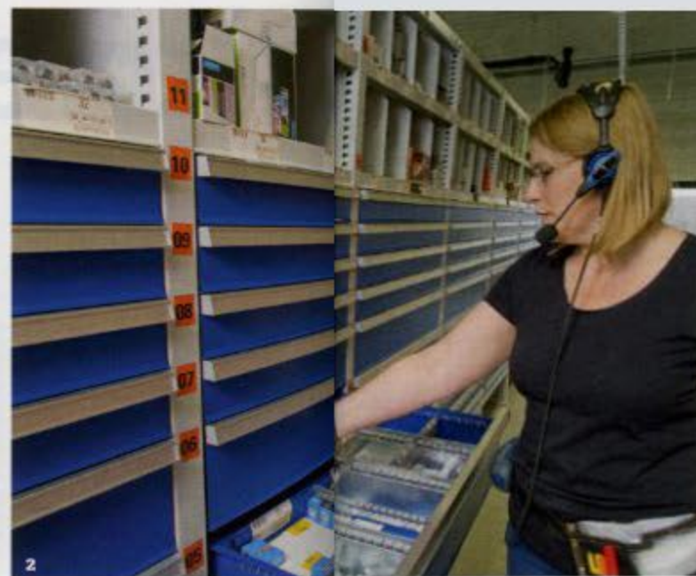
1 Schubladenpark für Kleinteile mit Anbindung an das durchgängige Weiterreichsystem. 2 Der Schubladenpark sorgt für kompakte Lagerung und kurze Kommissionierwege.
