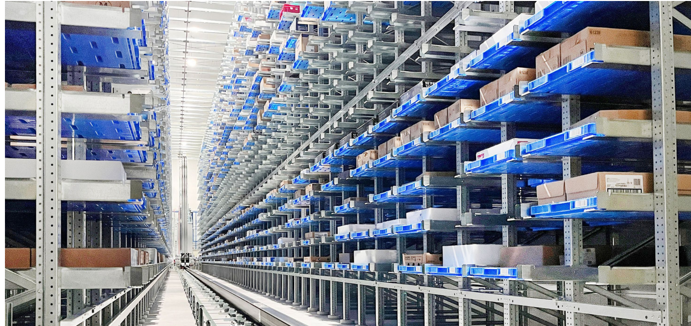
Automatiseret dybfrostlager med opbevaring i bakker.
