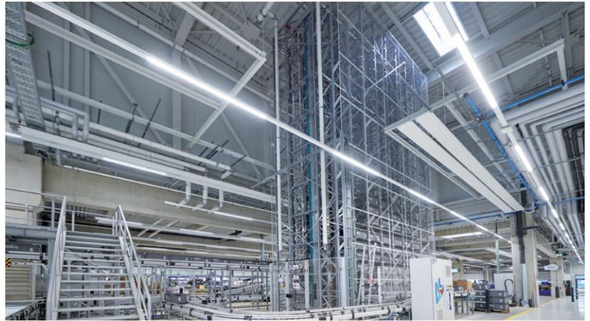
12 Meter hoher automatischer Auftragszusammenführungspuffer
