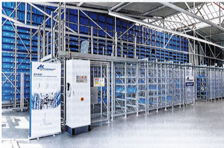
1 In hochautomatisierten Kleinteilelagern können Multilevel-Shuttles die Vorteile klassischer RBG und gängiger Shuttle-Systeme vereinen.
