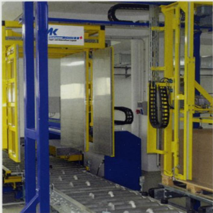
Bis zu 60 Paletten pro Stunde werden bei Sanofi von Holz- auf Hygiene-palette und umgekehrt gewechselt
