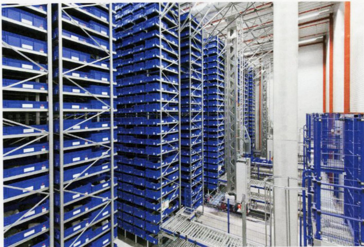
Im Automatischen Kleinteilelager mit 40.800 Behälterstellplätzen werden die Kabelsätze gesammelt und bis zum Vormontageabwurf gepuffert.
