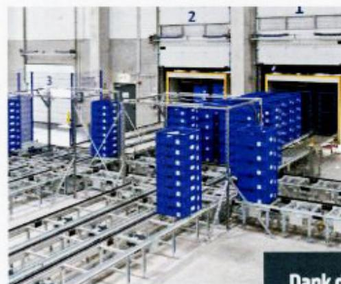
Verladen der Behälterstapel über eine automatisierte Fördertechnik auf den LKW
