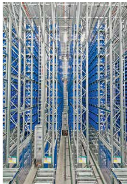
Hochverfügbares AKL mit Notfallkonzept – zwei Regalbediengeräte können auf das gleiche Regal zugreifen.
