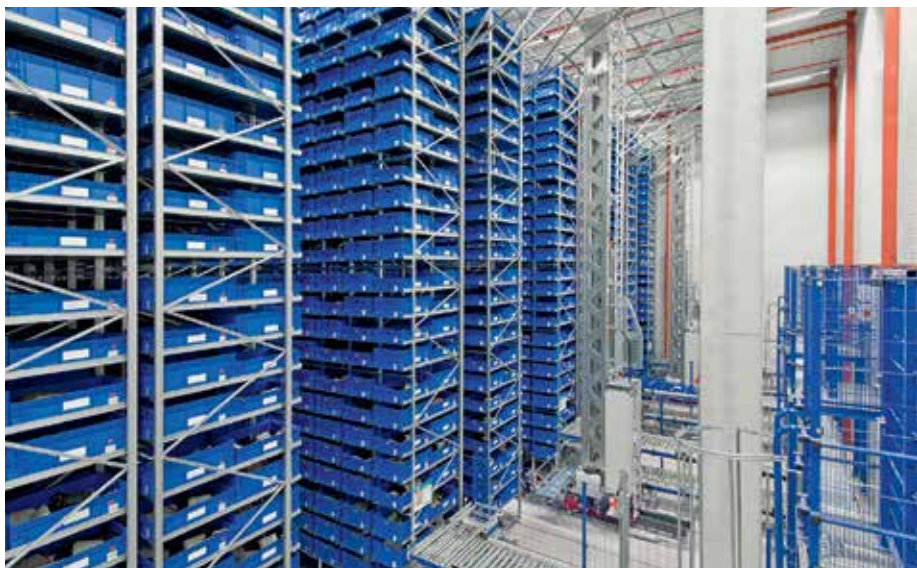
Im AKL 1 mit 40.800 Behälterstellplätzen werden die Kabelsätze gesammelt und bis zum Vormontageabruf gepuffert.
