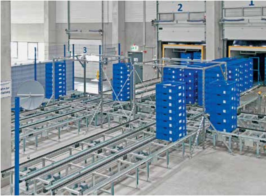
Verladen der Behälterstapel über eine automatisierte Fördertechnik auf den Lkw.
