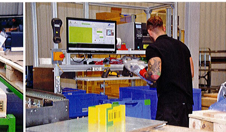
Der Kommissionierprozess funktioniert nach der Erweiterung über Touchscreen-PC und Bildverarbeitung.
