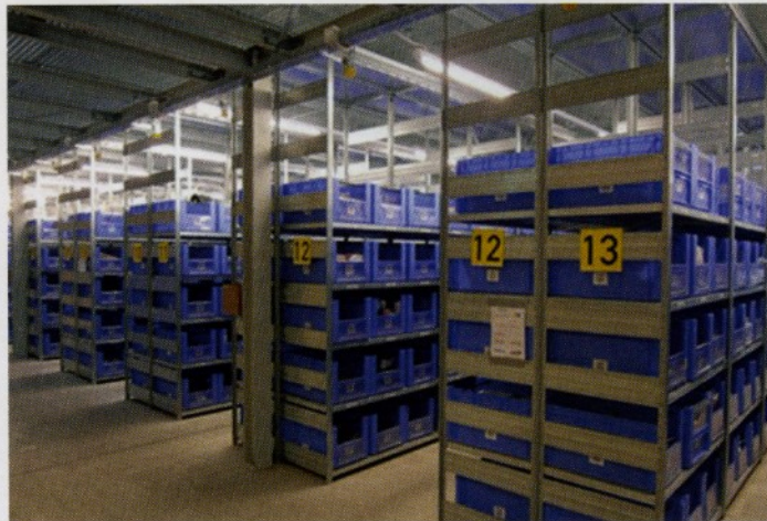
Das Fachbodenlager kann bis zu 21 000 Behälter aufnehmen
