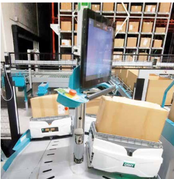
Kommissionierarbeitsplatz mit Skypod-Roboter
