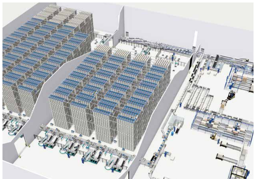
Exotec System mit 51.000 Tablaren und 79 Skypods
