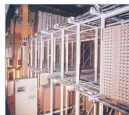
*Automatisches Paletten-Durchlaufgerät von Gervais-Danone, Ochsenfurt*
