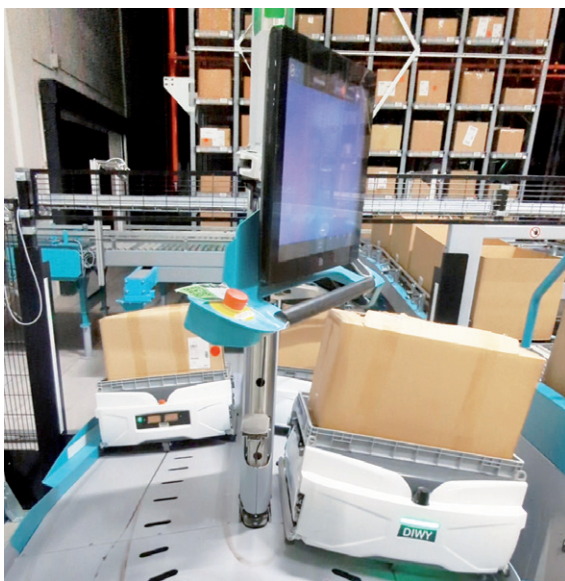
Kommissionierarbeitsplatz mit Skypod-Roboter
