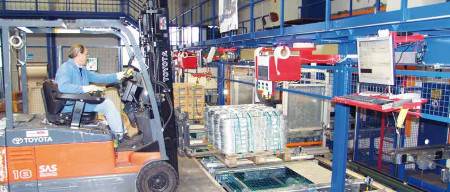
Kommissionierzone: Neben der händischen Kommissionierung ist auch die komplette Entnahme und Bereitstellung mit dem Stapler möglich
