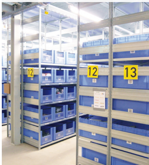
Fachbodenlager mit 21.000 Behälterstellplätzen
