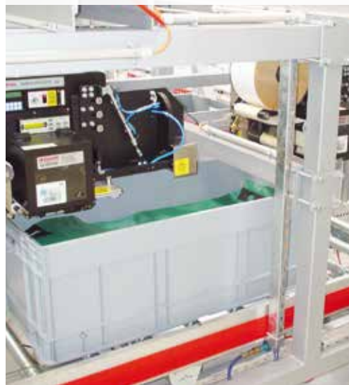
Drucker mit Applizierer - doppelt ausgelegt und über dem Behälter hängend
