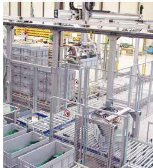
Handlingsgeräte können sowohl Wareneingang als auch Warenausgang erledigen
