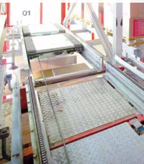
„Doppelmuli“ im vollautomatischen Silolager
