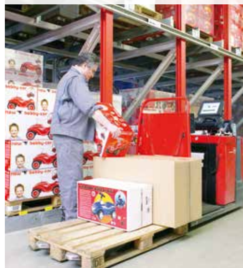
Kommissionierung per Datenfunk
