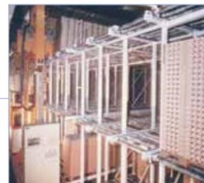
1977: Damals wegweisend – automatisches Paletten-Durchlauflager von Gervais-Danone, Ochsenfurt
