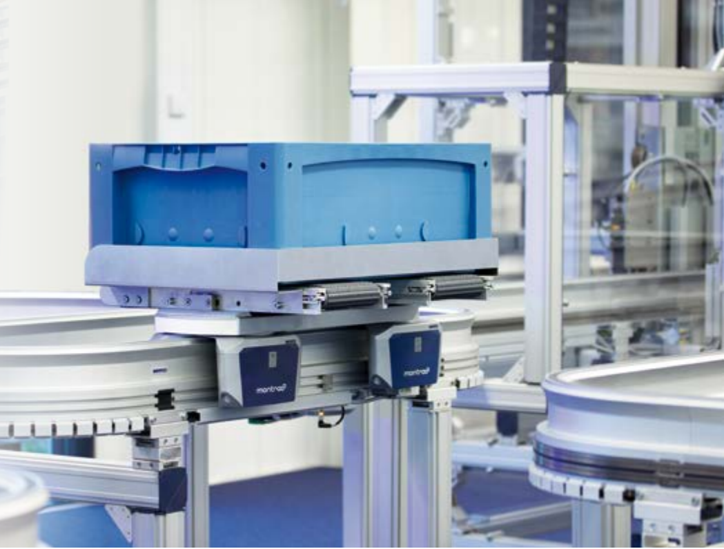
montrac®-Transportsystem mit Anbindung an das Kleinteilelager
