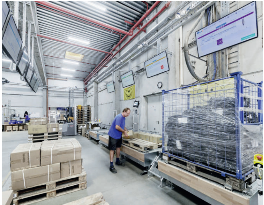
Fördertechnische Anbindung von Multi-Order-Picking-Plätzen mit Displays für Paletten mit vier Entnahme- und acht Zielplätzen.
