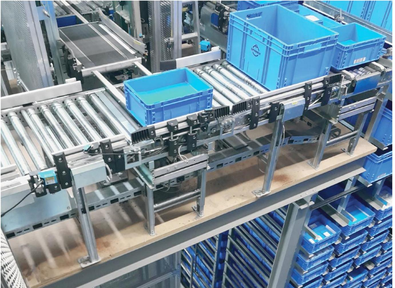
Klinkhammer realisierte ein Retrofit-Projekt für die Spinner Gruppe. Der Umfang der Modernisierung: ein AKL mit zwei Regalbediengeräten und einer Vorzonenförderertechnik, sowie erneuerte Steuerungstechnik.
