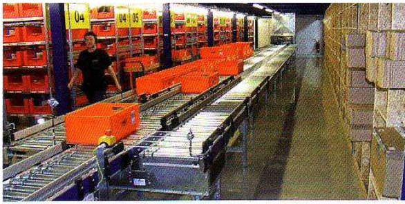
Bild 1 Der Auftragsbehälter fährt nach dem Auftragsstart über die Förderstrecke die verschiedenen Bahnhöfe an, wo die Mitarbeiter, unterstützt durch Pick-by-Voice und Scanner, die benötigten Artikel aus der Fachbodenregalanlage kommissionieren.
