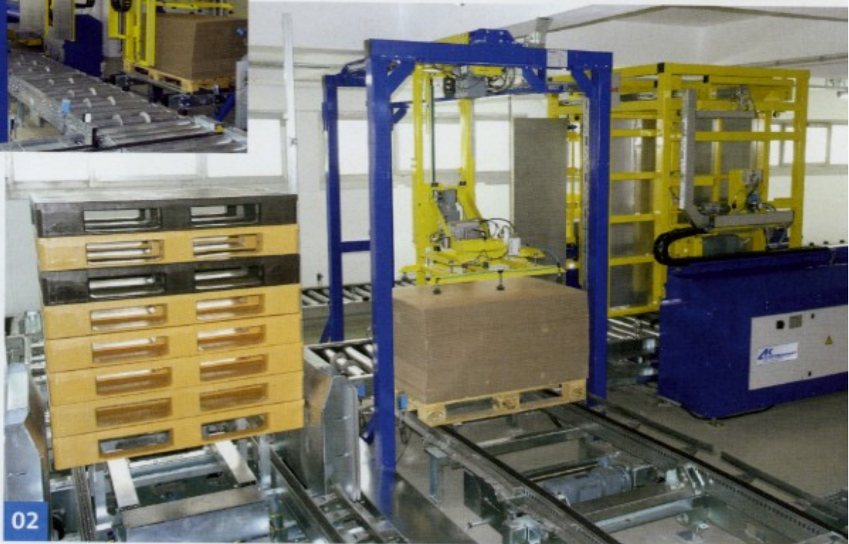
02 Bis zu 60 Paletten pro Stunde werden von Holz- auf Hygienepaletten und umgekehrt gewechselt
