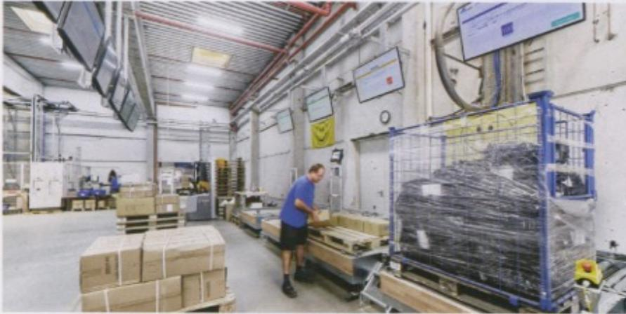
▲ Fördertechnische Anbindung von, mit Displays ausgestatteten, Multi-Order-Picking-Plätzen für Paletten mit vier Entnahme- und acht Zielplätzen.
