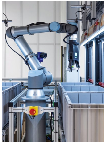
Vollautomatischer Roboter kommissioniert aus sechs Behältern in einen Zielkarton.
