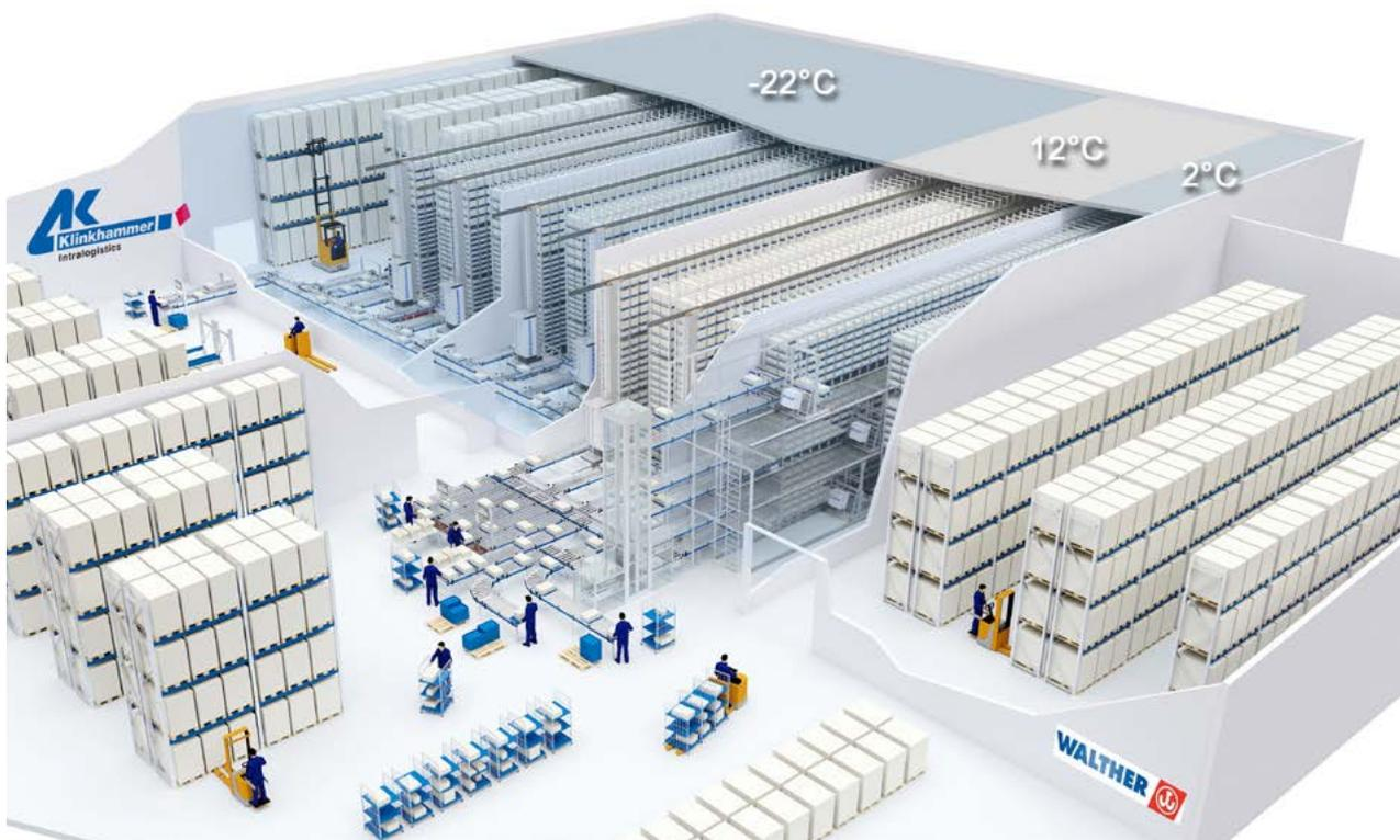
**Beispiel eines Automatiklagers in drei Klimazonen bei Frischdienst Walther: Im automatischen Tiefkühlager mit Regalbediengerät stehen 19.680 Tablarstellplätze zur Verfügung.**
