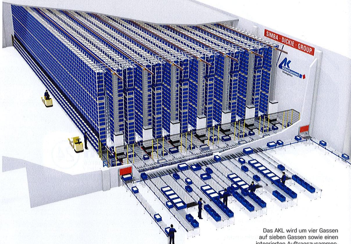
Das AKL wird um vier Gassen auf sieben Gassen sowie einen integrierten Auftragszusammenführungs-Puffer erweitert.
