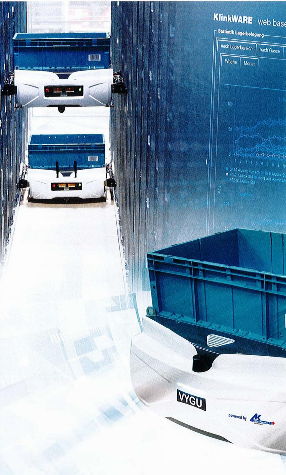
Der Nürnberger Systemintegrator erweitert sein Produktportfolio um das französische Shuttle-System von Exotec. Die selbstfahrenden und an Regalstützen emporkletternden Fahrzeuge eignen sich für Kleinteilelager. Sie entnehmen die Behälter und verfahren sie als FTS zum Übergabepunkt.
