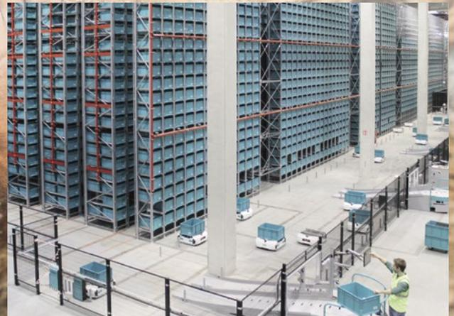
zielt werden. Auch die Lagerkapazität des Behälterlagers ist erweiterbar – durch einen Anbau an die bestehende Regalanlage. In der Regel ist dafür ein Stillstand nicht nötig.
