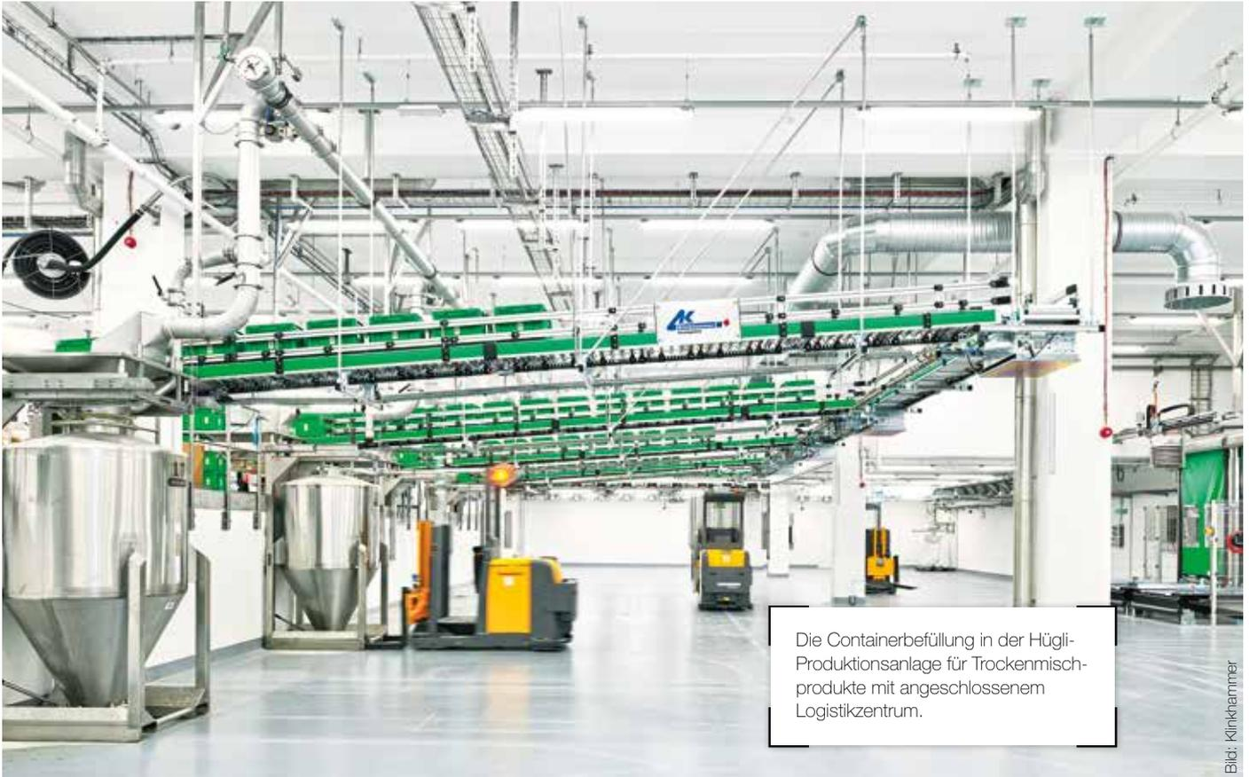
Die Containerbefüllung in der Hügli-Produktionsanlage für Trockenmischprodukte mit angeschlossenen Logistikzentrum.
