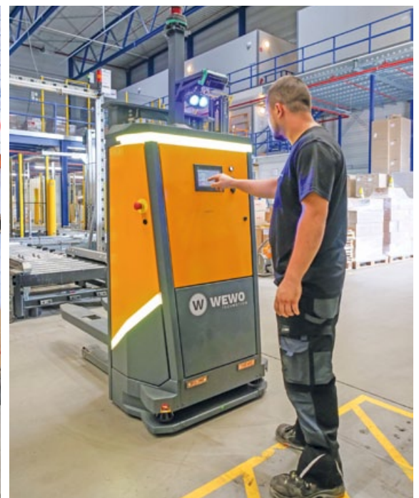
An insgesamt neun Abholquellen nimmt das FTF Paletten selbstständig auf, befördert diese und gibt sie im Versand wieder ab.
