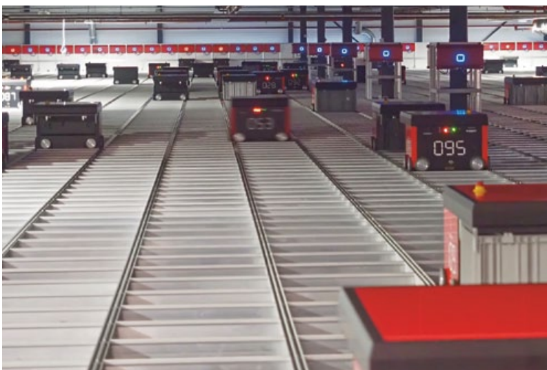
Die Kommissionierroboter werden aus einem AutoStore-System mit 85.000 Behältern gespeist.
