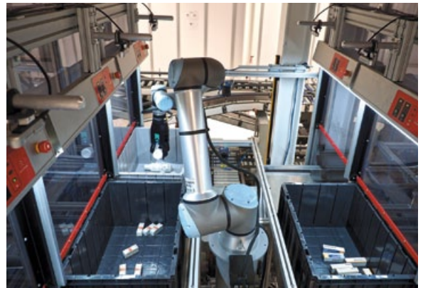
Ein Kommissionierroboter greift Pharma-Produkte aus sechs Kisten. Dank neuer Auslagerstrategie funktioniert dies nun noch effizienter.
