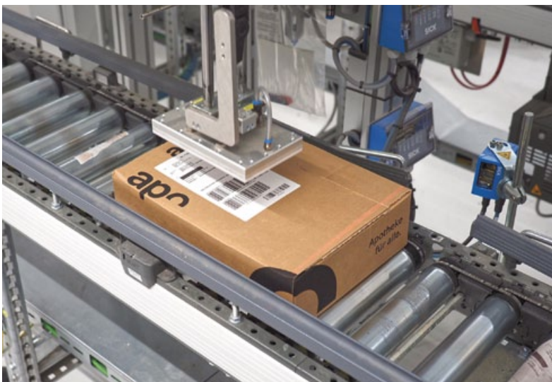
Nach voll-automatischer Prüfung des Paketinhalts auf Übereinstimmung mit der Bestellung erfolgen auch das Verschließen des Kartons sowie die darauffolgende Etikettierung ohne menschliches Zutun.
