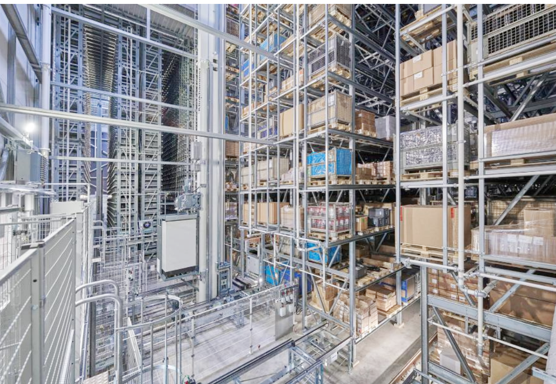
Das zweigassige, automatische Paletten-Hochregallager mit 4.900 Stellplätzen.
