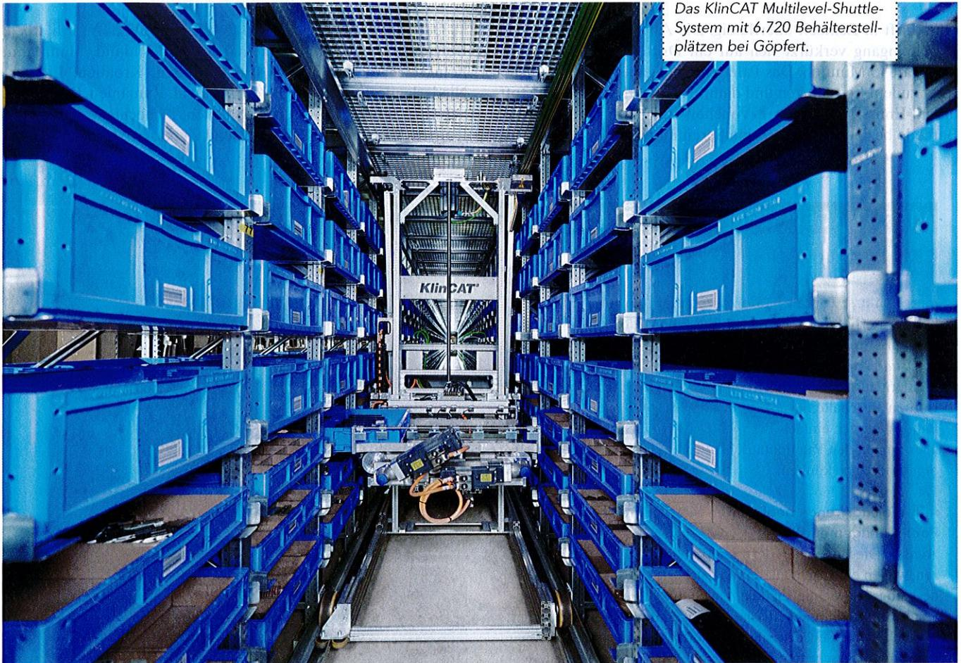
Das KlinCAT Multilevel-Shuttle-System mit 6.720 Behälterstellplätzen bei Göpfert.
