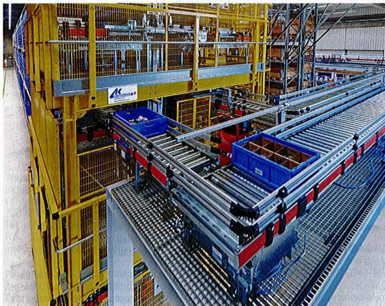
Die Vorzone des Multi-Level-Shuttles mit Fördertechnikbühne.
