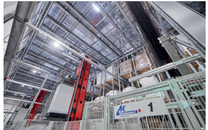
01 Das inertisierte Hochregallager in Silo-Bauweise bietet mehr als 10 000 Palettenstellplätze
