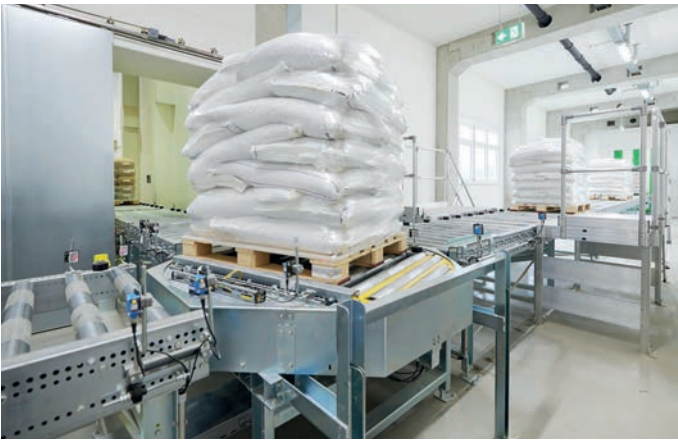
02 Anbindung zum Produktionsgebäude über Palettenfördertechnik
