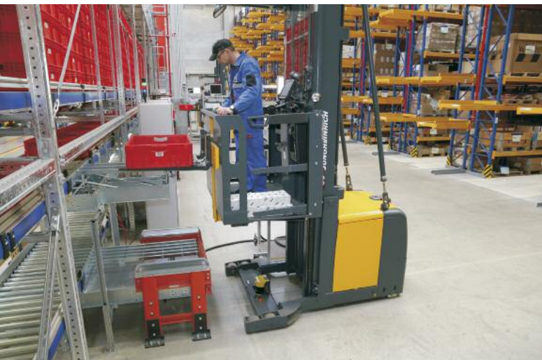
Nach der Abgabe der Kommissionierwanne kann sofort die Leerwanne unterhalb des Speichers aufgenommen werden
