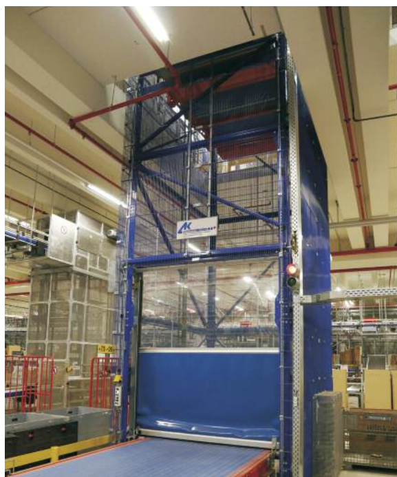
Reversierbarer Vertikalförderer auf Grundlage der Modulbandfördertechnik mit optischer Anzeige
