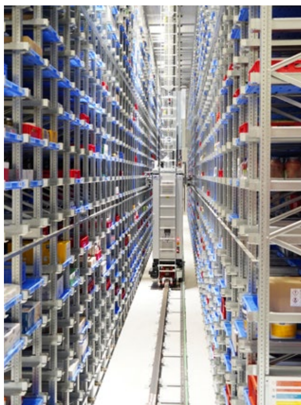
Automatisches Kleinteilelager mit Regalbediengerät.
