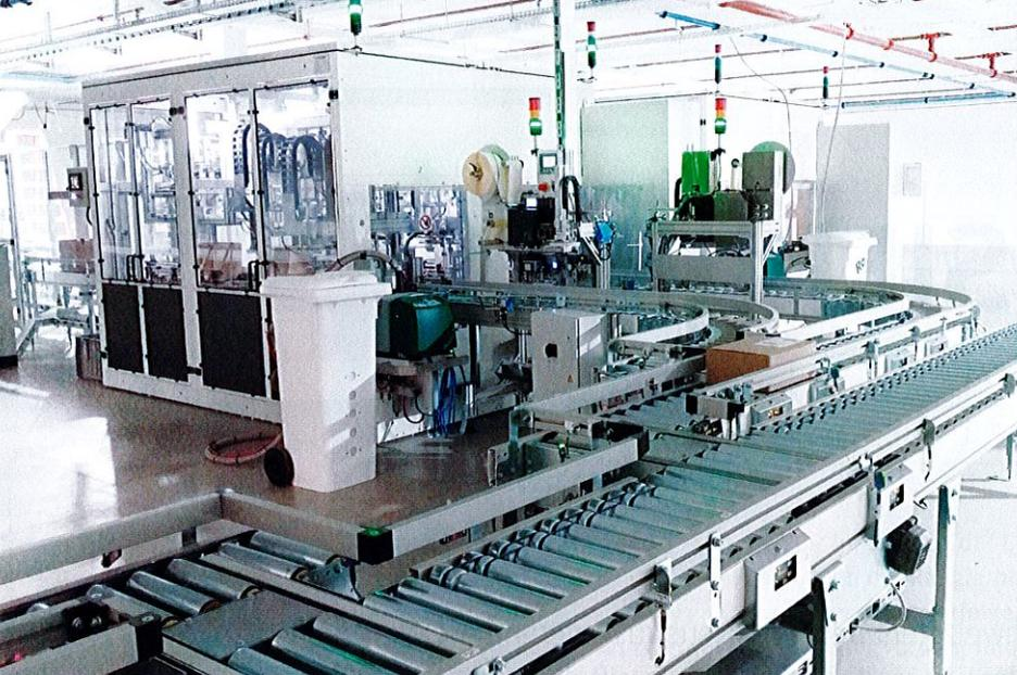
Automatischer Kartonverschleißer mit Fördertechnikbindung.
