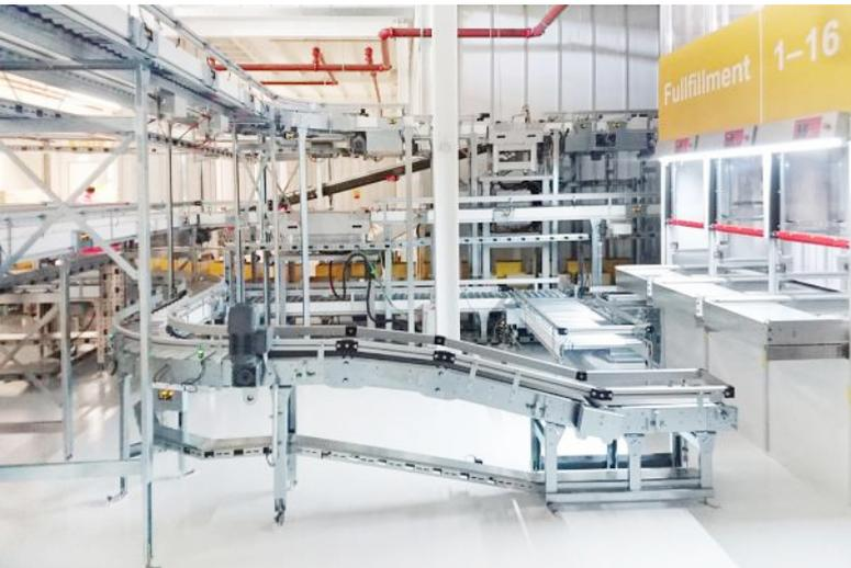
Fördertechnik zur Roboter-Kommissionierzelle.
