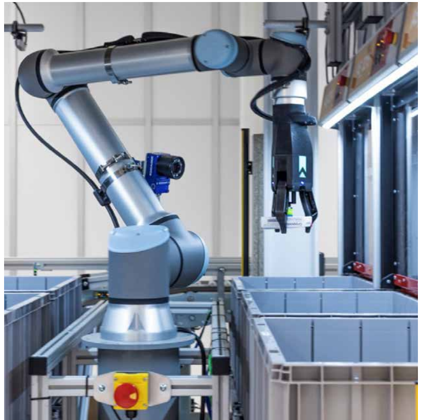
Vollautomatischer Roboter kommissioniert aus 6 Behältern in einen Zielkarton
