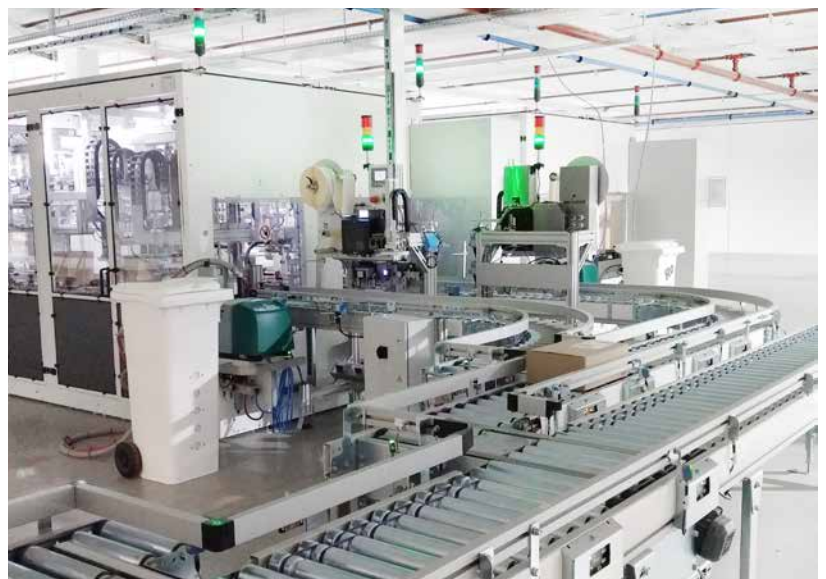
Automatischer Kartonverschließer mit Fördertechnikbindung
