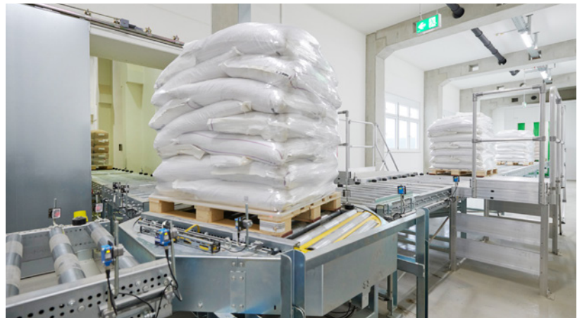
Anbindung zum Produktionsgebäude über Palettenfördertechnik
