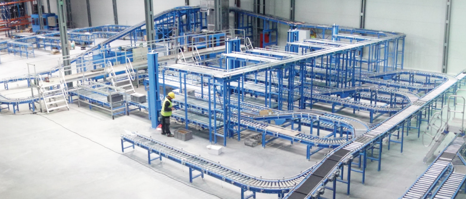
Das Shuttlelager ist fördertechnisch an 6 Kommissionier- und 16 Versandarbeitsplätze angebunden
