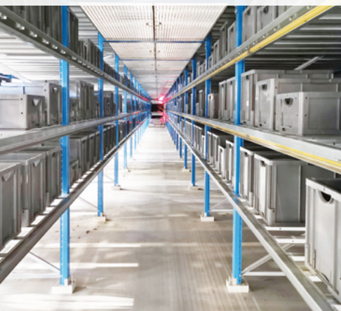
Automatisches Shuttlelager mit 38 Shuttles
