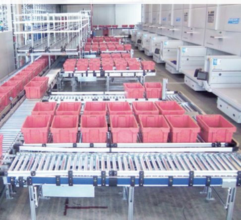
18 Liftlager mit 9 Kommissionierplätzen und automatischem Nachschubpuffer
