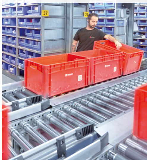
Fachbodenlager mit 30.000 Stellplätzen und Kommissionierung per Pick-by-Voice
