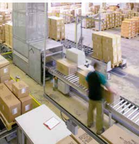
Lagervorzone mit Nachschub für das Kommissionierlager
