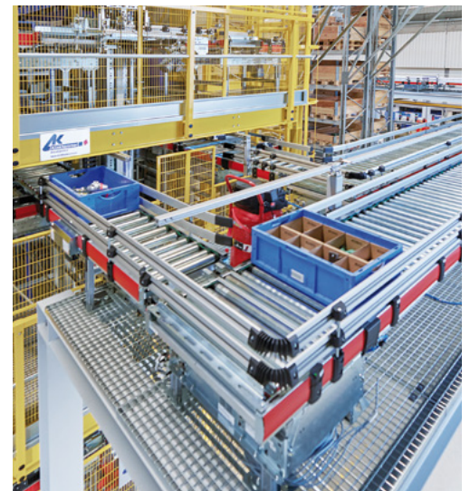
Vorzone des Multilevel-Shuttles mit Fördertechnikbühne
